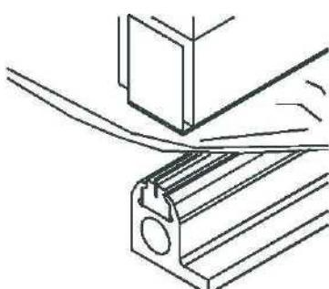
Запайка и резка осуществляются электрическим импульсом, автоматически регулируемым с помощью электроники. Запаечный нож находится под температурой заставляющей пленку таять. Давление между запаечным ножом и тефлоновым покрытием находится под контрастом, вызывающим разделение двух концов пленки.
