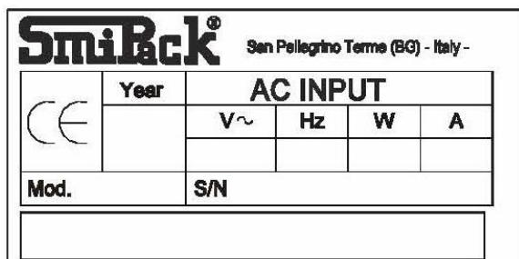
На задней стенке каждой машины Вы сможете найти табличку с маркировкой Европейского Сообщества, содержащую основную информацию о машине: название машины, серийный номер, электрическое напряжение и т.д.
