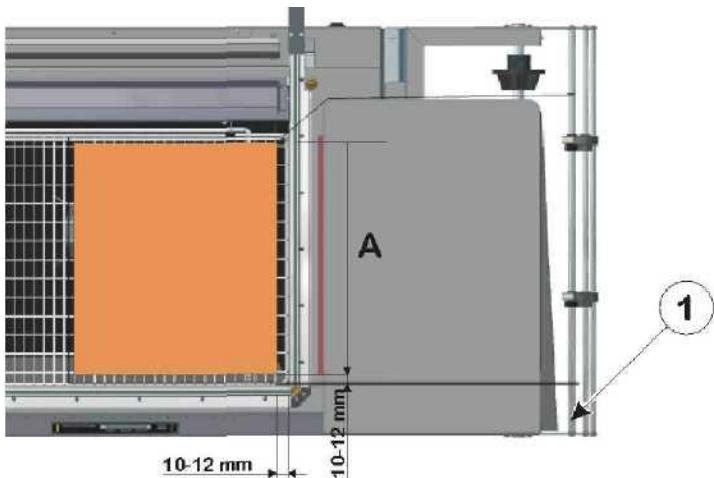
Кронштейн-держатель пленки 1 должен быть установлен по ширине А. Оптимальное необходимое расстояние между предполагаемым швом и продуктом 1-2 см.
