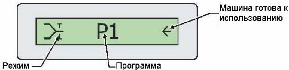
В левом углу дисплея Вы увидите символы, обозначающие, выбранный режим (запайка или термоусадка). В центральной части дисплея отображена выбранная программа. В правом углу символ «мигающая стрелка», отображающий готовность машины к работе.
