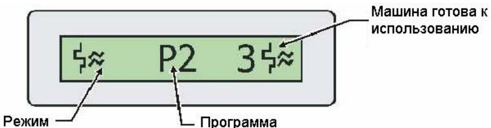
В режиме термоусадки символ, обозначающий данный режим мигает до тех пор, пока температура термоусадочной камеры не достигла нужной величины. В правой части дисплея Вы видите цифры, показывающие повышение температуры (1-4). Как только температура достигла нужной величины можно начинать процесс термоусадки.
