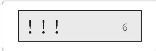
Показанный код (в правой части дисплея) позволяет определить тип ошибки, которая вызвала помехи в работе машины и как следствие звуковой сигнал.
