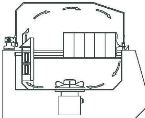
Усадка пленки происходит одновременно с резкой с помощью обдува упаковки потоком горячего воздуха.
